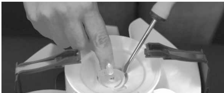
Fig 7. Retirer la bague de verrouillage ... faire levier à l'aide d'un petit tournevis ...
