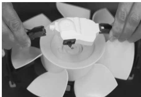
B.... le placer alors entre les bras du compartiment moteur ...
